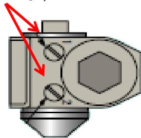
2つネジがある場合、1つはドアが大きく開いた状態から、閉じる直前までの速度調整。残り1つが、ドアが閉じる直前から閉じるまでの速度調整です。お好みで速度を調整してみてください。
